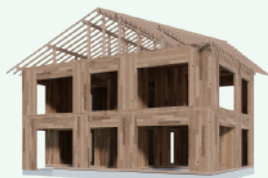
CLT パネル工法
