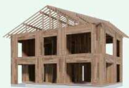
CLT パネル工法
